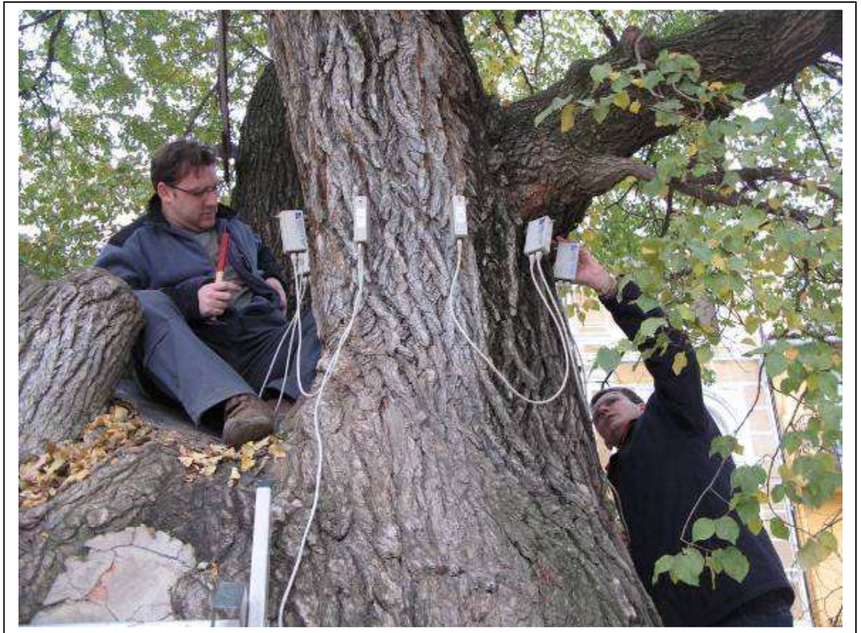
Figura 3. Sensores de ARBOTOM en la rama principal derecha, a 255 cm del suelo
